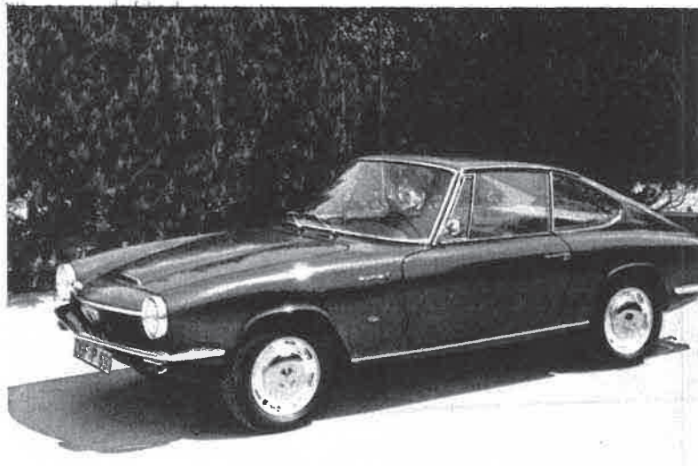
GLAS 1300 GT — 85 PS — 174 km/h GLAS 1700 GT — 100 PS — 186 km/h
