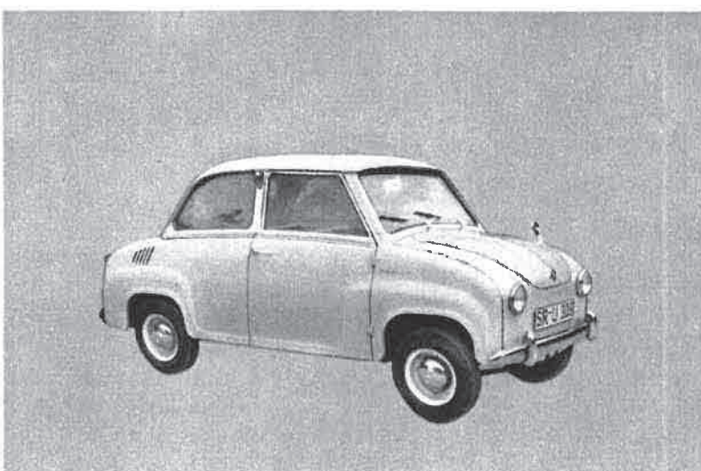
Goggomobil T 250 — 13,6 PS — 80 km/h Goggomobil T 400 — 18,5 PS — 100 km/h
